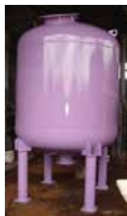
Tanques de Saturação
